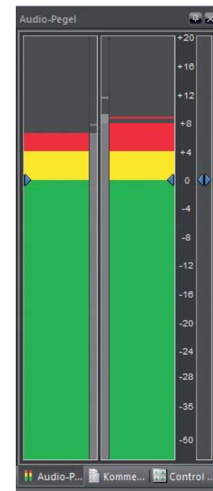
Die Aussteuerungsanzeige in Wings 4 mit der Skala K-20
